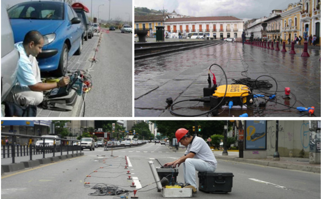
Adquisición datos ReMi para caracterización ruta de metros en Madrid-España (2005), Quito-Ecuador (2011) y en Caracas, Venezuela (2011).
